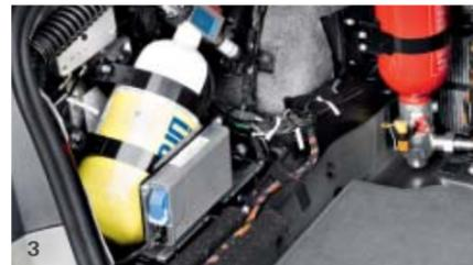
**1.** Notausstieg über die Frontscheibe, mit pyrotechnischer Unterstützung. **2.** Feuerlöschanlage mit Löschmittelbehältern im Kofferraum. **3.** Frischluftanlage mit Luftbehälter im Kofferraum.
