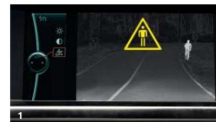
**1.** BMW Night Vision erkennt Personen und bestimmt deren Position sowie Entfernung. Gegebenenfalls wird eine Warnung ausgelöst. **2.** Die Tasten für die Wechselsprech- und Alarmanlage sind für den Fahrer leicht zu erreichen – aber von außen kaum einsehbar. **3.** Favoritentasten ermöglichen den schnellen Zugriff auf sicherheitsrelevante Funktionen. **4.** Über iDrive lassen sich unter anderem Einsatzinstrumente steuern.
